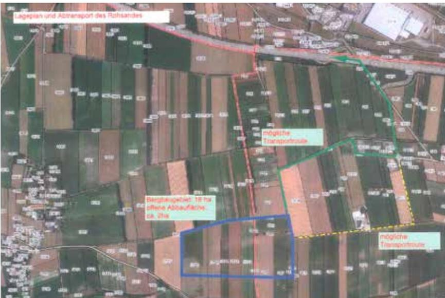
Dieses Abbaugelände ist begrenzt, hat die Form einer Linse, ist ca. 18 ha groß und erstreckt sich über mehrere Grundstückspartellen. Der Quarzsand ist mit einer 4 – 8 Meter dicken Erdschicht bedeckt und erstreckt sich ca. 15 Meter in die Tiefe. Gerechnet wird mit einer Gesamtmenge Sand von 2,7 Mio t, welche in 25 Jahren abgebaut werden soll.
